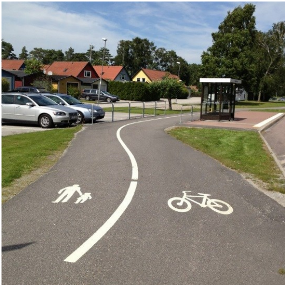
Figur 3. Exempel på separering mellan gående och cyklister, längs med Inre Ringleden. Bild: ÅF
