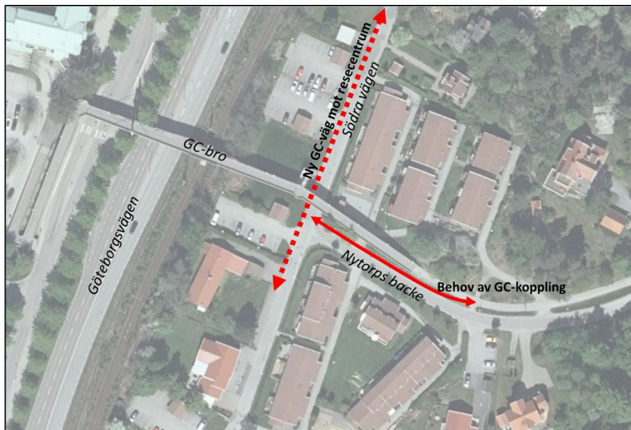
Figur 29. Behov av ny gång- och cykelkoppling mellan Nytorps backe och den planerade gång- och cykelvägen utmed Södra vägen (Bildkälla: Lantmäteriet med bearbetning av Sigma Civil)
