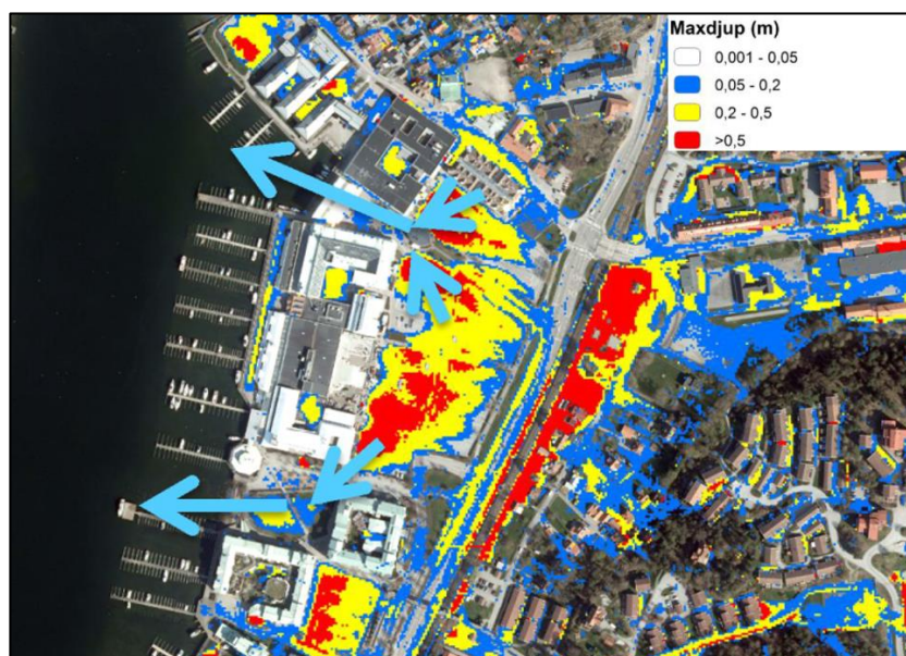
Figur 21. Förslag på avledningsstråk för skyfall
