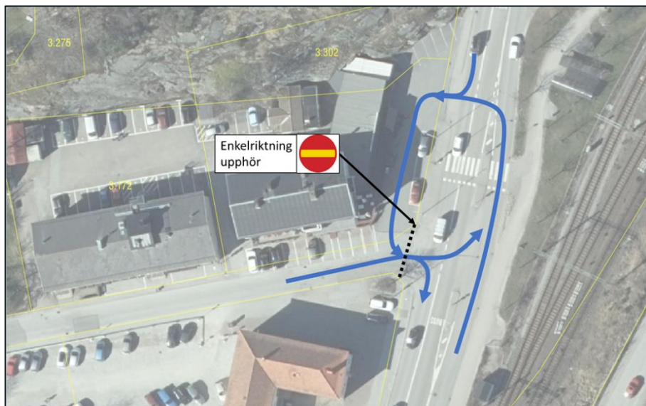
Figur 4. Föreslagen utbredning av enkelriktningen på CW Borgs väg, fram till korsningen med Göteborgsvägen. Bildkälla: Lantmäteriet, bearbetad av Sigma Civil.
