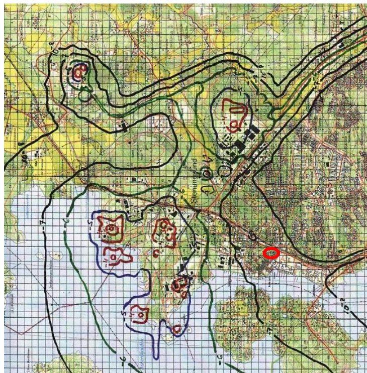
Figur 15. Riskkonturer för total individrisk enligt Säkerhetsstudie Stenungsund (AJ Risk Engineering AB, 2015). Studerat planområdes lokalisering anges med röd markering.
