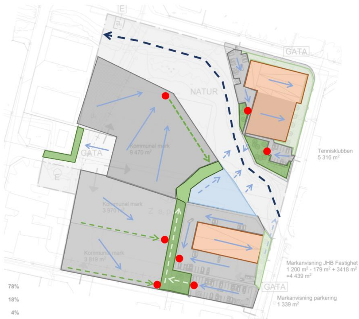
Figur 21 Systemförslag med skiss på dagvattenlösningar. Röda prickar är oljeavskiljare, ljusgröna fält är infiltration i mark av takvatten, mörkgröna fält är stråket med rening/fördröjning av dagvatten från asfalterade ytor. Blå pilar visar vattnets rinnvägar.
