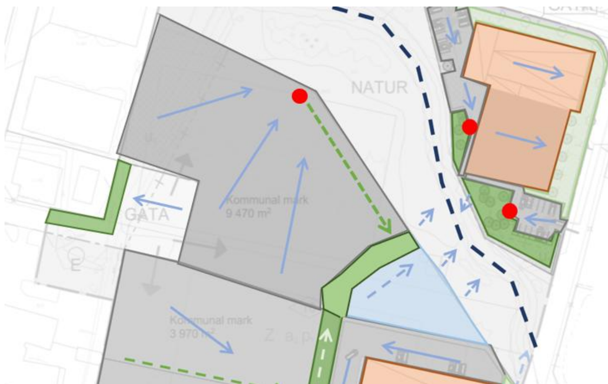
Figur 27. Dagvattenhantering för kvarter A. Blåa pilar visar flödesvägar, grått område yta som bidrar till avrinning mot svackdiket och röda prickar visar oljeavskiljare.
