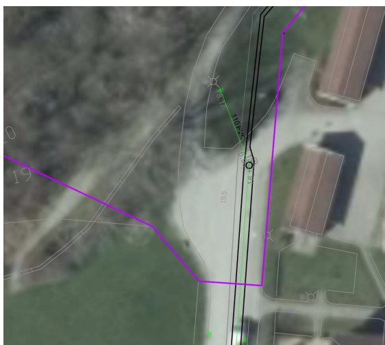
Figur 13. Inlopp till ledningsnät för dagvatten vid Ranehedsvägen. Violett linje utgör plangräns.
