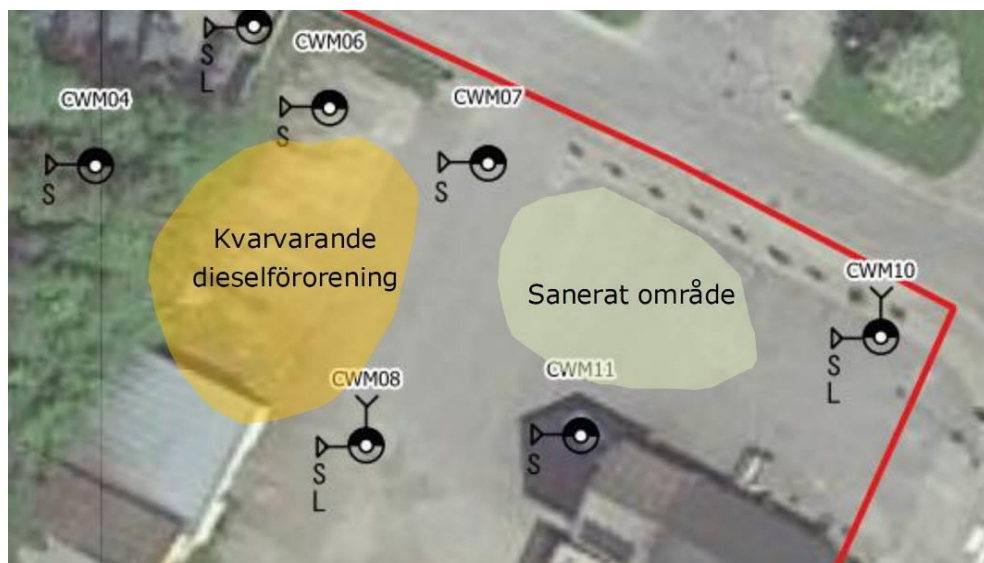
Bild från Miljöteknisk markundersökning om tidigare utförd sanering samt kvarvarande dieselförorening.
