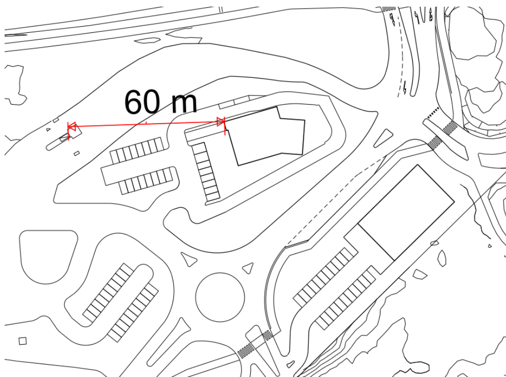
Figur 22 Avståndet mellan mätarskåp/påfyllnadsanslutning cistern till snabbmatsrestaurangen.
