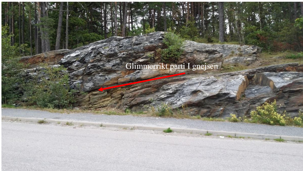
Figur 10 Foto över häll i den norra delen av detaljplaneområdet (ID 4), invid befintlig GC-bana, som visar sämre bergkvalitet. Vy mot väster.
