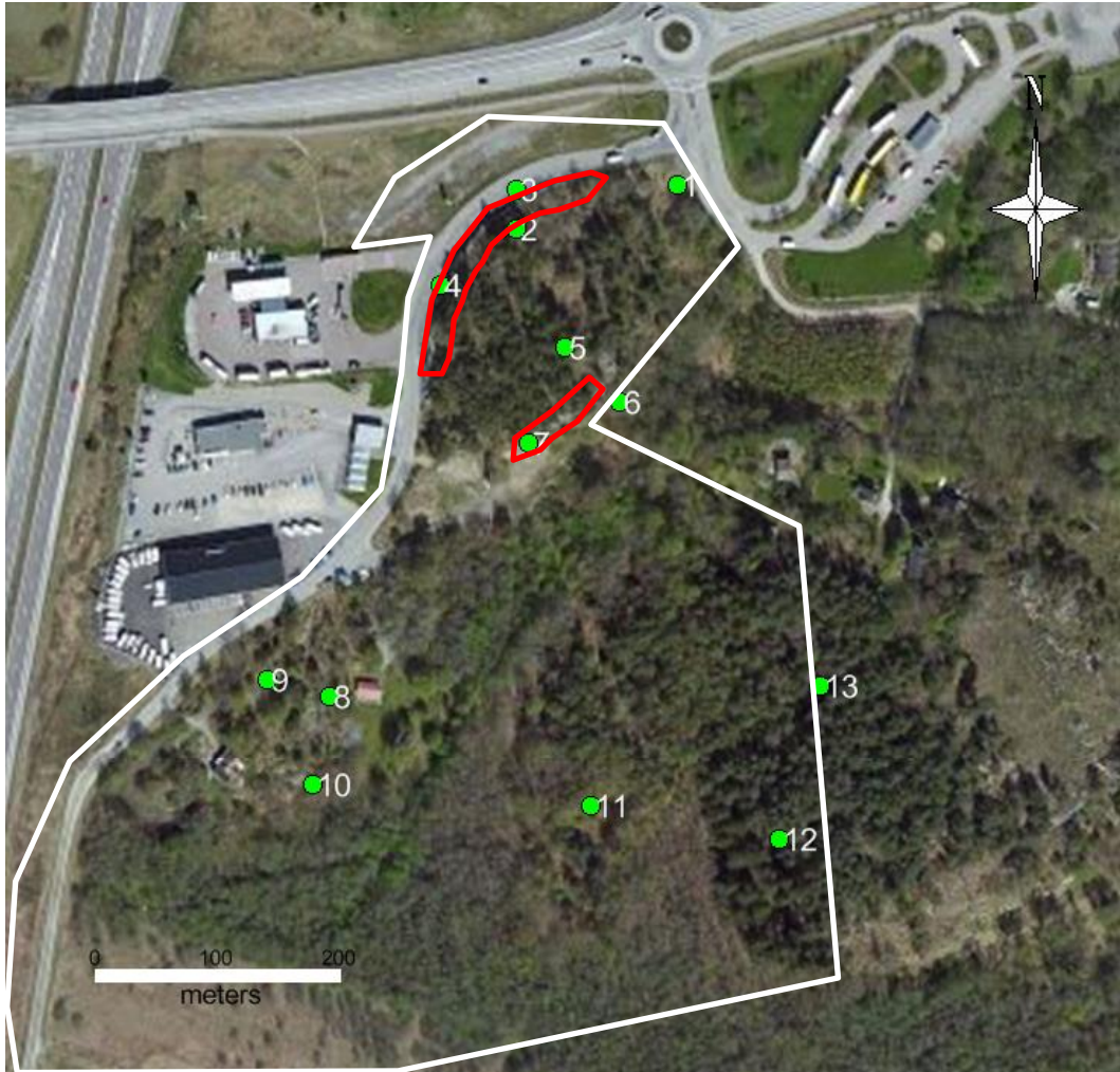
Figur 7 Flygfoto med undersökt detaljplanområde. Vit markering visar ungefärligt planområde och gröna punkter är gjorda observationer. Röd markering visar områden med lokala svaghetszoner med glimmerrika partier.
