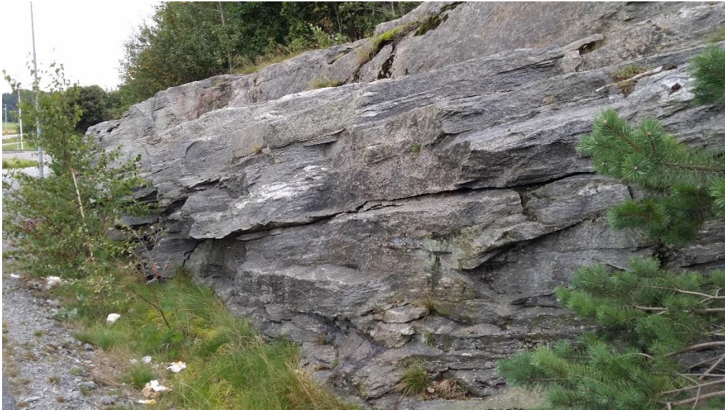
Figur 9 Foto över häll, vy mot öster, i den norra delen av detaljplaneområdet (ID 3), invid befintlig GC-bana, som visar sämre bergkvalitet med öppna sprickor.
