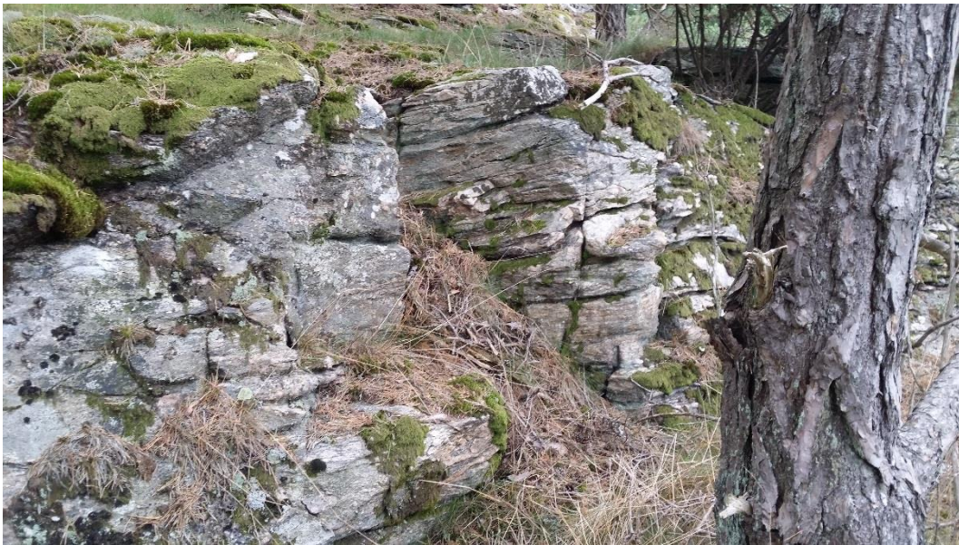
Figur 12 Foto över häll i den norra delen av detaljplaneområdet med vy mot öster som visar sämre bergkvalitet (ID 7) med ökad sprickfrekvens.
