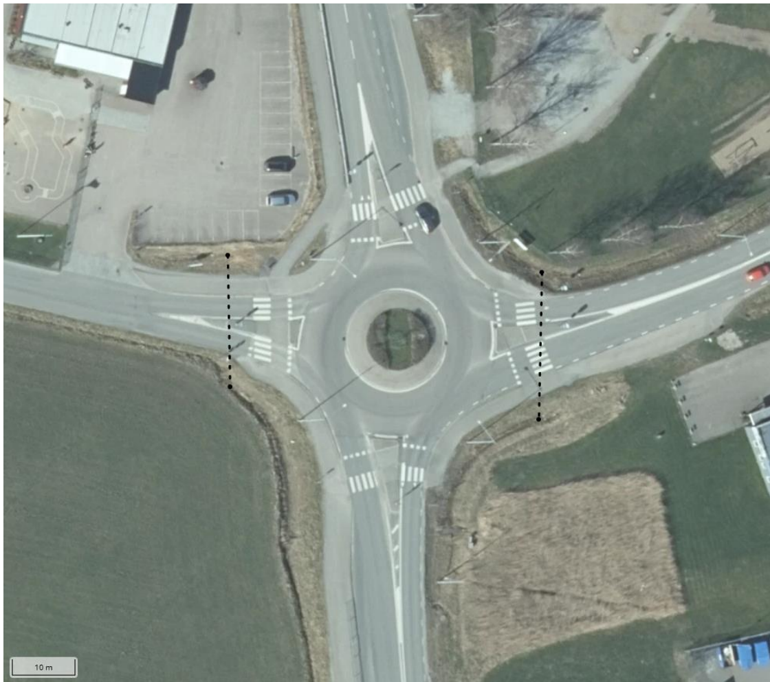
Figur 18. Ungefärlig placering av vägtrummor kring rondell strax öster om planområdet. Bild hämtad från Swecos kapacitetsutredning.
