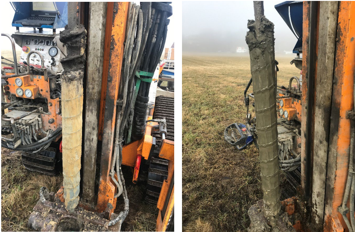
Figur 8. Jordprovtagning i punkt 2202 med skruvborr på bandvagn med markprofilen i 0-1 m djup (t.v.) respektive 2-3 m djup (t.h.).
