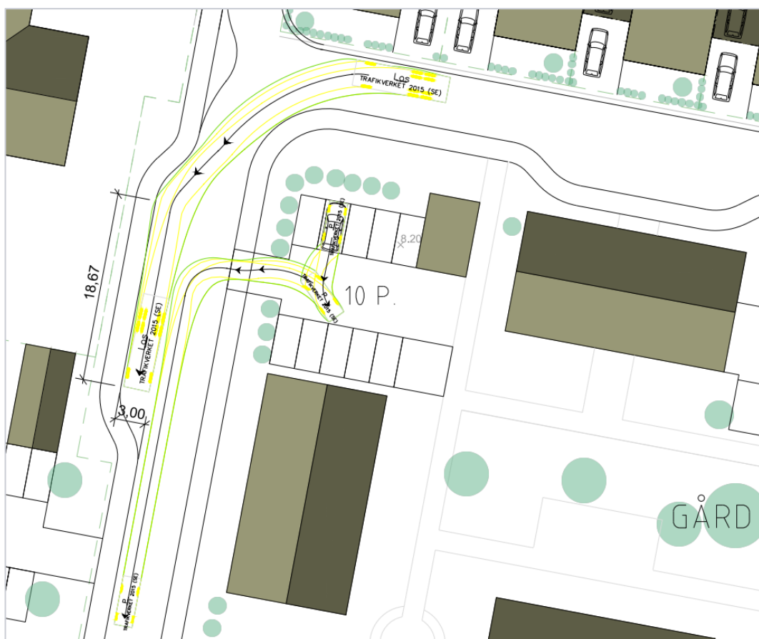
Figur 3. Bilden visar körspår för angöring med typfordon Los och körspår för utfart från parkeringsytan med personbil.
