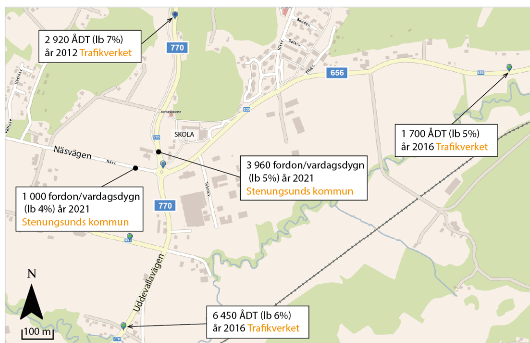
Figur 3. Uppmätta trafikflöden. Källa: Trafikverket och Stenungsunds kommun.
