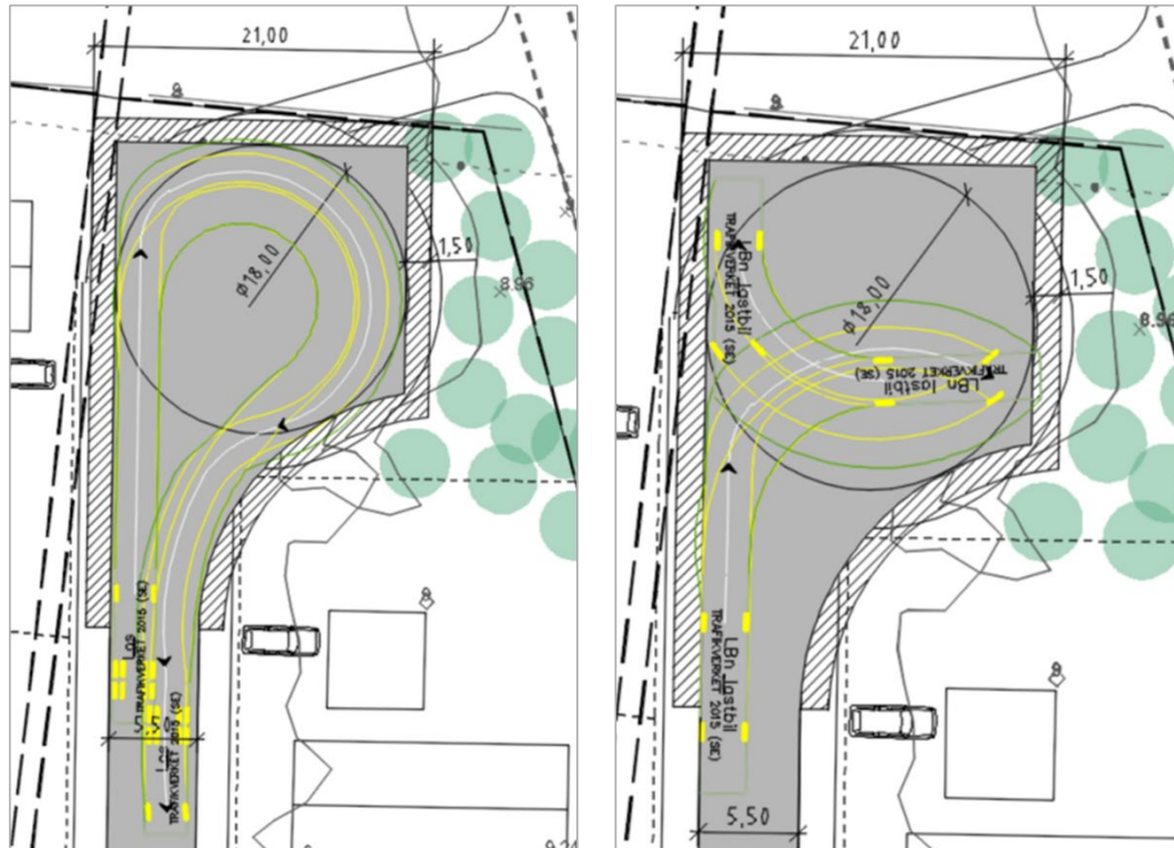
Figur 1. Till vänster redovisas körspår (gula linjer) för rundkörning med Los. Till höger redovisas körspår för backvändning med LBn. Det streckade området utanför vändplatsen är det hinderfria området.
