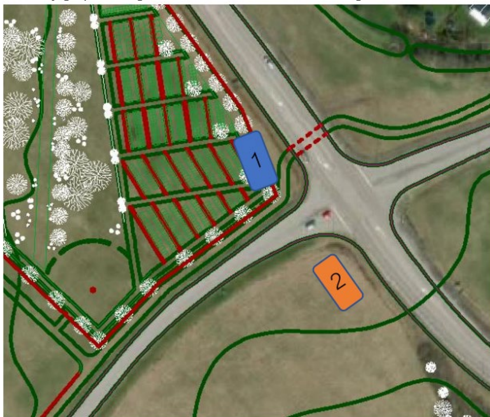
Pontarius, utsnitt ur va-och dagvattenutredning, förslag på placering av markbädd. förslagen är inte skalenliga.
