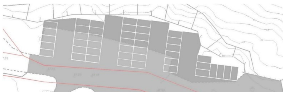
Sigma, utsnitt ur trafikutredning, möjlig utvidgning av parkeringsytan intill kyrkan. Mörkare grått anger ytor som kan tillkomma.
