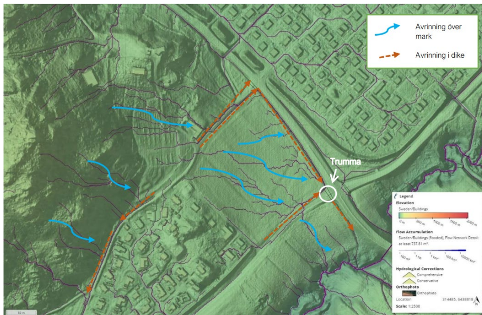
Pontarius, utsnitt ur va-och dagvattenutredning, modellbild från SCALGO Live som illustrerar avrinningsmönstret inom båda fastigheterna.
