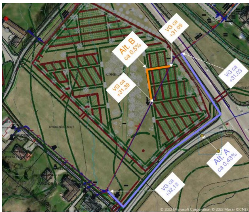
Pontarius, utsnitt ur va-och dagvattenutredning, förslag på omdragning av befintliga ledningar inom Kyrkenorum 1:1.
