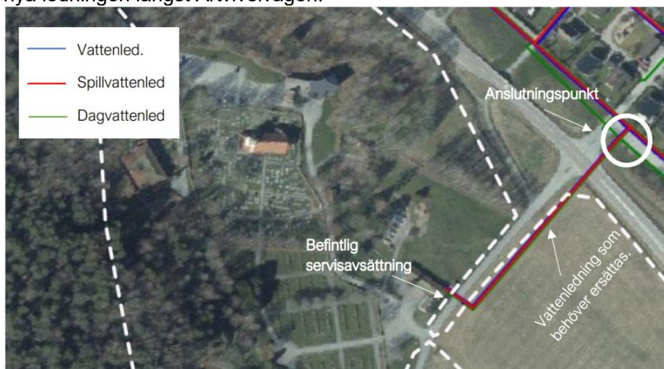
Pontarius, utsnitt ur va-och dagvattenutredning, redovisad anslutningspunkt samt lednings som behövs bytas ut för att erhålla tillräcklig kapacitet för brandposterna.
