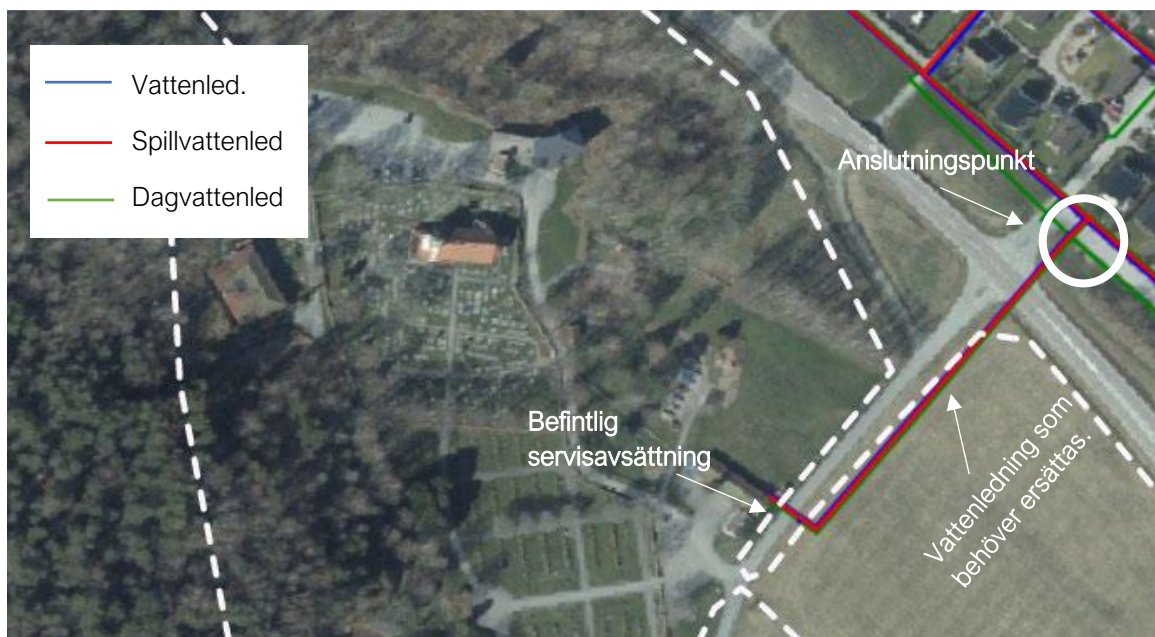
Figur 27. Redovisad anslutningspunkt samt lednings som behövs bytas ut för att erhålla tillräcklig kapacitet för brandposterna.
