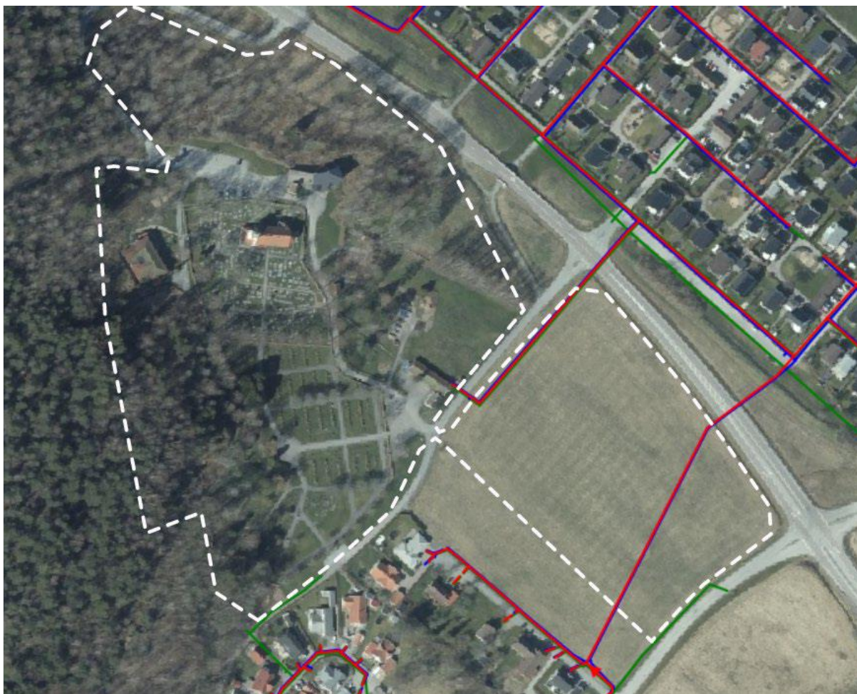
Figur 16. Befintliga VA-ledningar inom utbyggandsområdet. Finns inget underlag på hur ledningarna är lagda inom Kyrkenorum 7:2.
