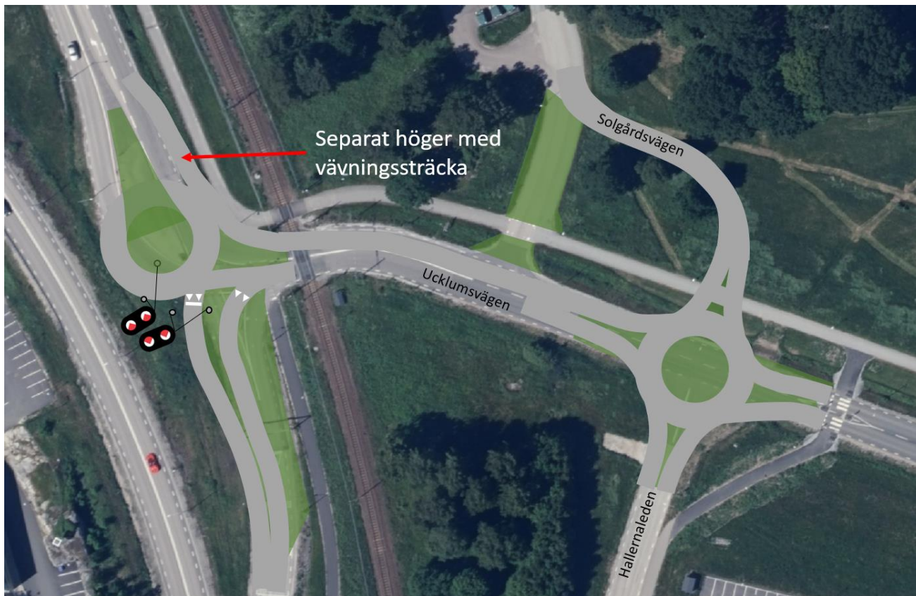
Figur 31 Skiss på cirkulationsplatser mellan Hallernaleden och Ucklumsvägen samt Göteborgsvägen och Ucklumsvägen. (Skissen är endast schematisk och behöver utredas vidare i nästa skede)
