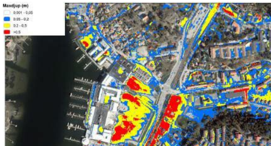
Resultat från översvämningsmodell. Maximalt vattendjup i centrala Stenungsund vid ett 100-årsregn. Ramböll, 2017.
